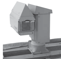
夜間でも波の形まで鮮明に撮影することが可能な高性能カメラを設置
