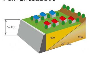
傾斜地に盛土した造成地で、盛土する前の地盤面の水平面に対する角度が20度以上で、かつ、盛土の高さが5m以上のもの
